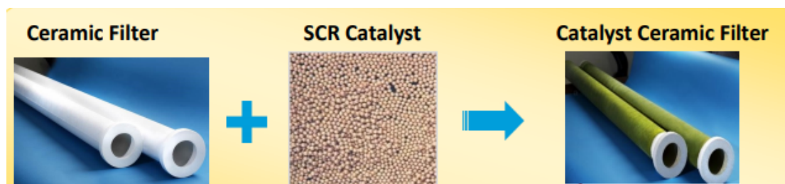
图 10 除尘脱硝一体化陶瓷膜原理图
